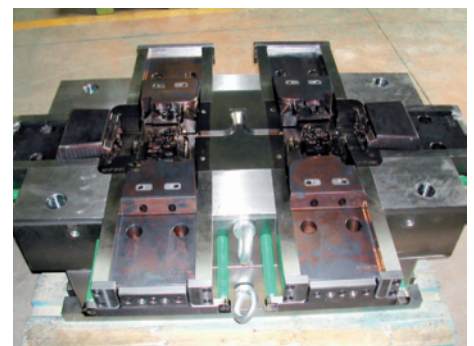
Gli stampi per pressofusione di leghe leggere (alluminio e leghe di zama) vengono costruiti per importanti gruppi tedeschi, ma anche per molti clienti italiani
