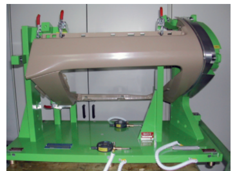
Le dime sono un'altra specializzazione di Hanns Engl; si tratta di attrezzature meccaniche di precisione utilizzate per il controllo dell'assemblaggio finale di prodotti
